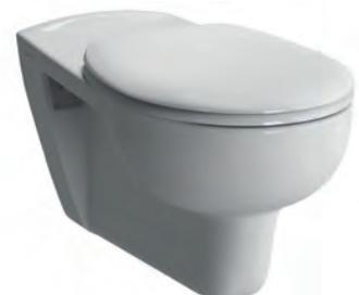
Adapté pour chaise roulante, capacité de chasse d'eau 3/6 litres. Montage surélevé requis pour l'obtention d'une hauteur de siège de 480 mm, selon DIN 1385-6, DIN-EN 38, DIN 18040, DIN-EN 997. Livrée avec tubulure rallongée.
